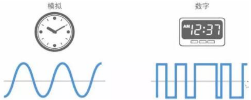
图 33: 模拟信号是连续信号, 数字信号是离散信号
